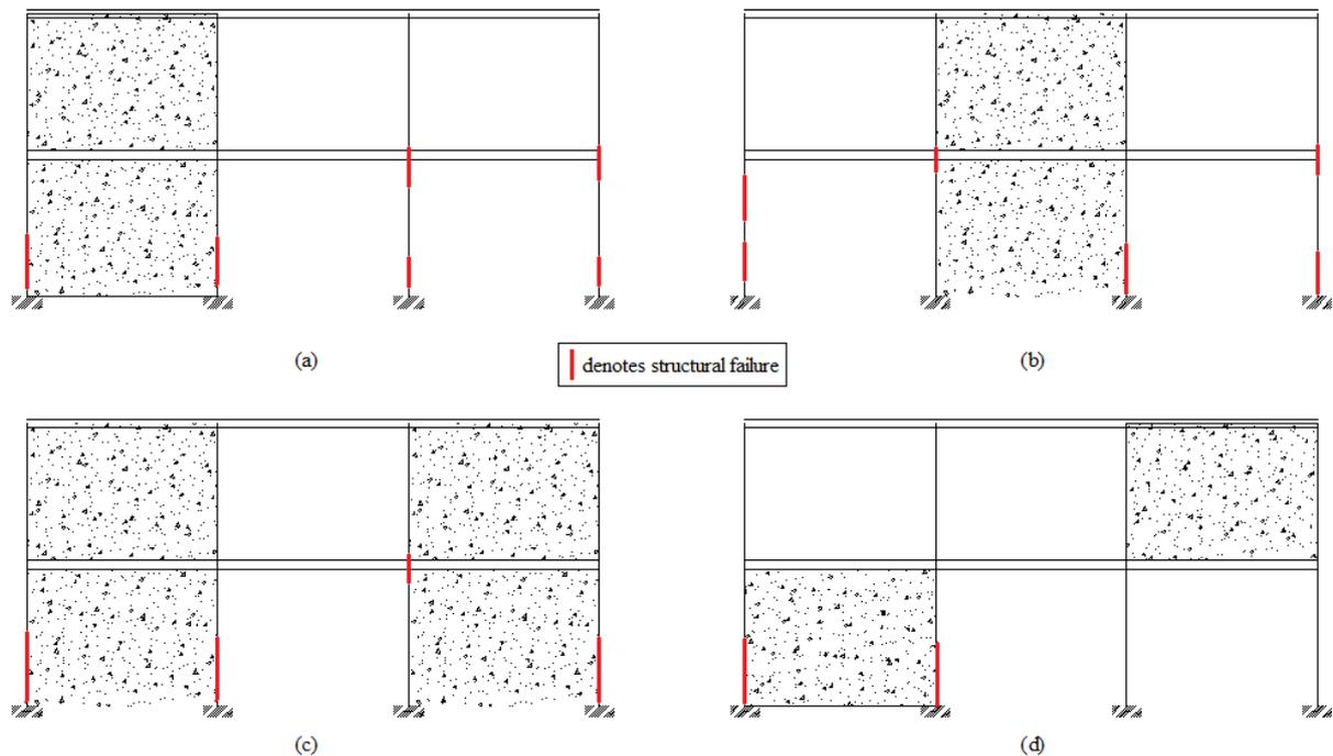
**Figure 3.6.** Structural failure: (a) Model 2; (b) Model 4; (c) Model 6 and; (d) Model 8
